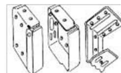
**Embout de boîtier et support intermédiaire pose de face; plafond ou tableau**
